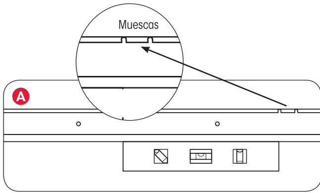
**CONSEJO** • Los rieles superiores tienen una parte superior y una parte inferior. La **PARTE SUPERIOR** está señalada en la etiqueta y tiene **dos muescas** para insertar adecuadamente los soportes para colgar. (Figura A)
